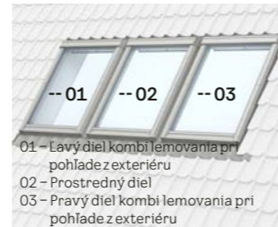
Trojica strešných okien vedľa seba s krokvmi
